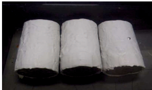
図 4-4 10%NaCl 溶液浸せき試験の状況
