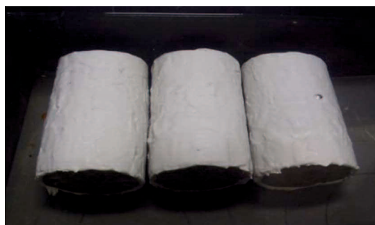
図 3-4 10%NaCl 溶液浸せき試験の状況
