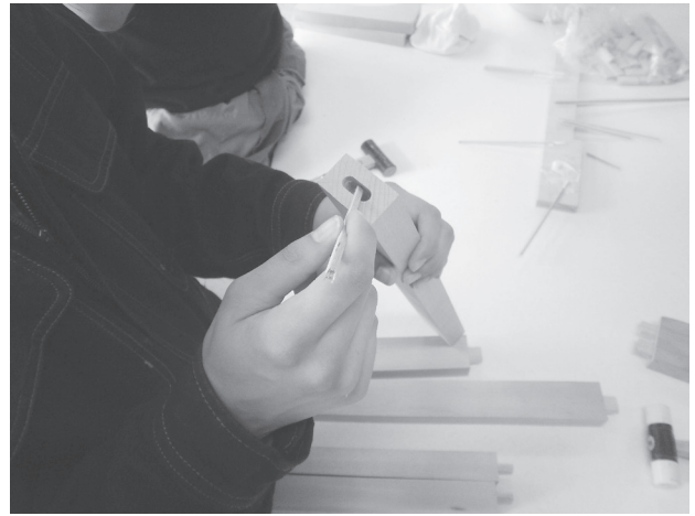
図6 ホゾ穴にボンドを塗布する様子
