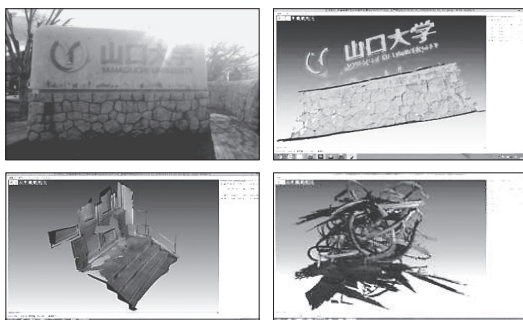
図4 原理上、計測不良を起こしやすい対象物
