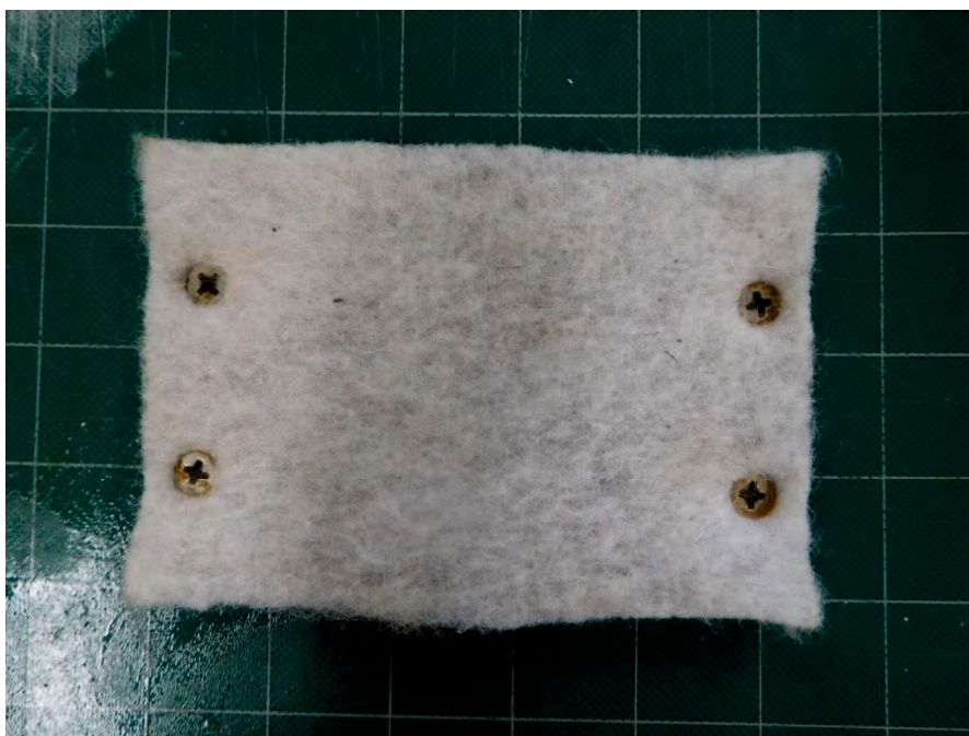
(a) 鋼材の上に固定した不織布
