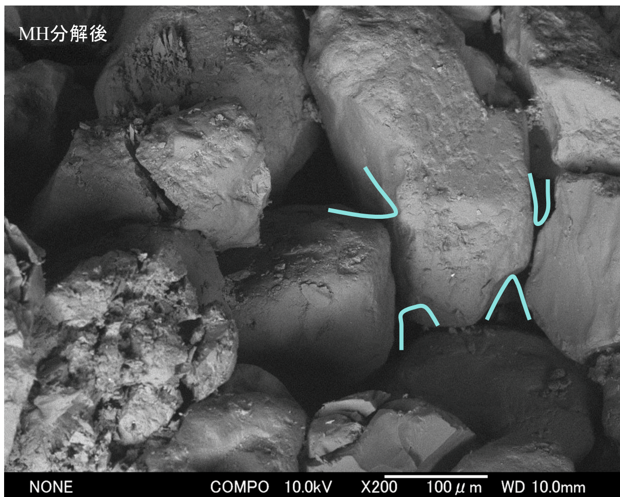
図 2-2-14 分解後の供試体中のメタンハイドレートの様子の写真倍率 200 倍 (米田, 2009 より引用)
