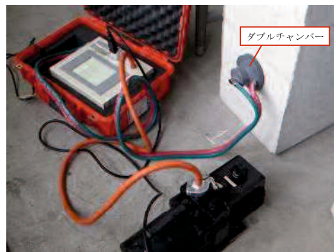
図 6.2.1 使用資機材（コンプレッサと測定器）
