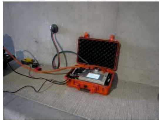
(透気試験状況)
