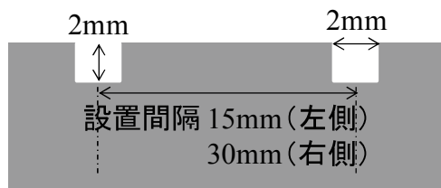
図 5. 2. 3 鋼板セラミック溶射の溝形状
