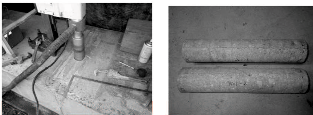
図-5.3.5 試験片採取状況（乾式コアドリル）
