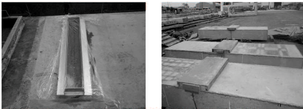
図-5.3.3 塩分供給状況（左：塩水湛水状況，右：暴露状況）
