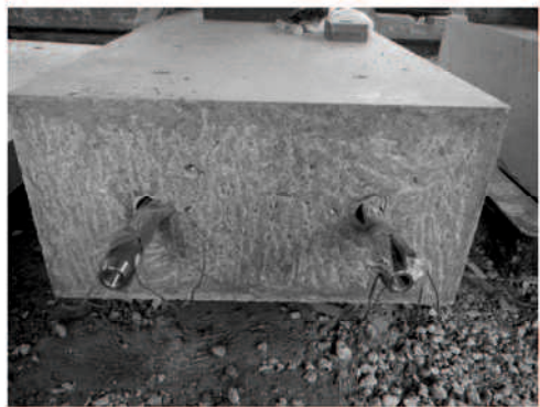
g) 打継ぎ処理状況 (PC-1)
