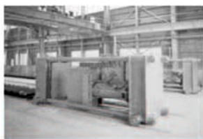
反力台・緊張ジャック
