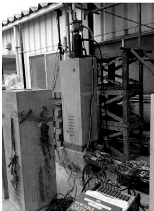
図-4.4.1 定着耐力実験状況
