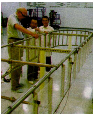
図 4.7 圧縮性流体中の非接触プロセス(直径 1.6mm, 600m のテフロン・チューブ)
