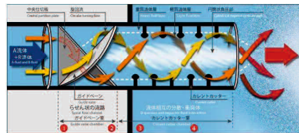
(f) OHR ラインミキサー (株OHR 流体工学研究所 HP より)
