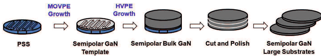
図1.13 半極性面GaN基板の新提案作製方法
