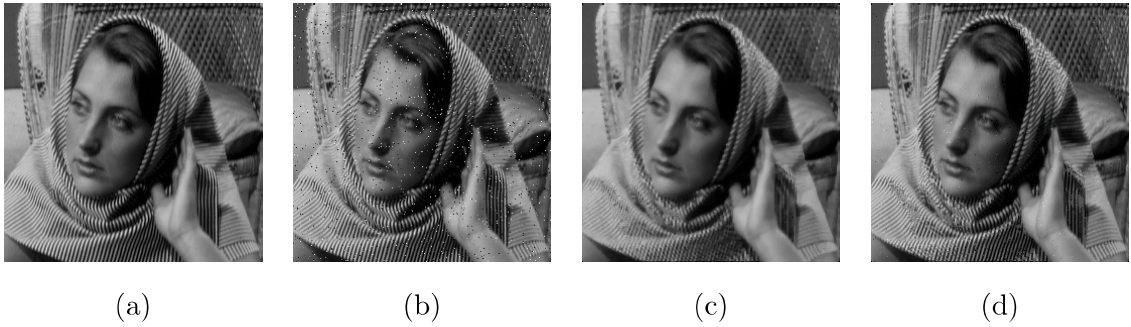
図 2.2: モノクロ画像のランダム値インパルス性雑音に対する MF, SM による雑音除去例 (a) 原画像, (b) 入力画像, (c) MF による雑音除去結果, (d) SM による雑音除去結果.
