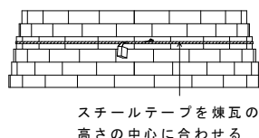
図3 周長および煉瓦寸法測定方法 (横から見た図)
