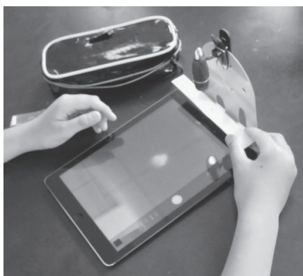
図9 ボールレンズ保持板を載せる位置を調整しているようす
