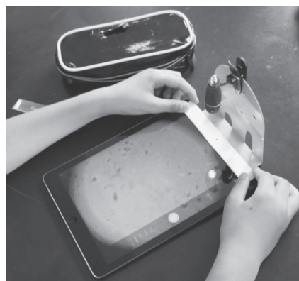
図10 タブレットPCにボールレンズ保持板を載せたようす
