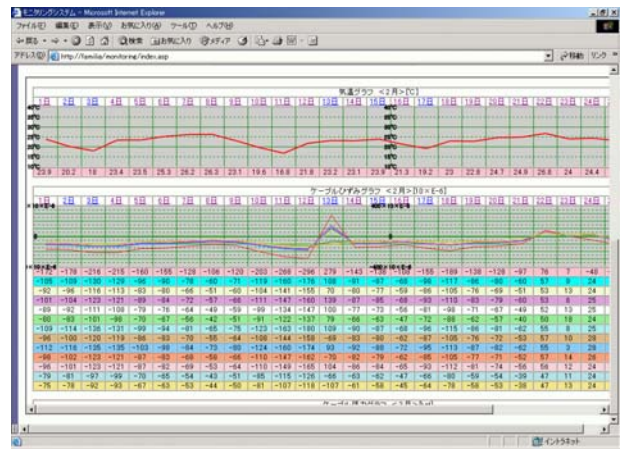
図-6 気温と斜材ケーブルのひずみ
