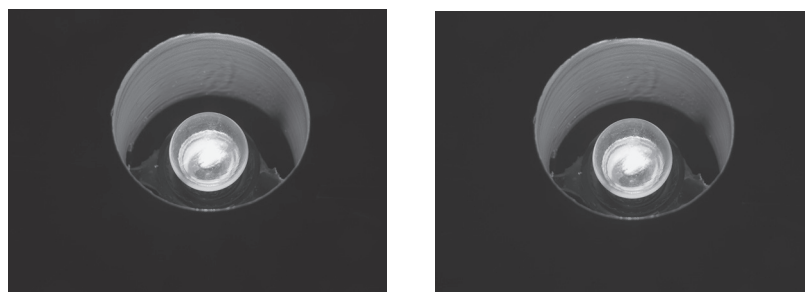
図4. 豆電球の明るさの変化が見られない様子。単一充電電池2個と豆電球（規格B:2.5 V, 0.3 A）を用いた場合で、左図が豆電球2個、右図が豆電球1個の時の様子を表す(表4下表に対応)。
