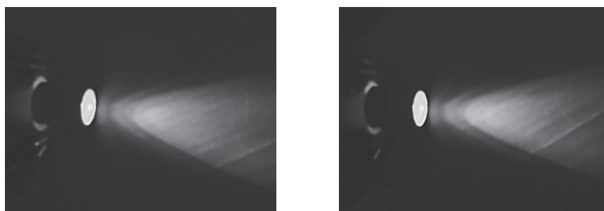
図5. LEDの明るさが変化していない様子。単一充電電池2個と青色LED（規格2.9-3.2 V）を用いた場合で、左図がLED、2個、右図が1個の時の様子を表す（表10に対応）。なお、直視による観測だけでなく机にあてた光にも変化が見られなかった。
