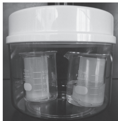
図7 簡易減圧器を使って簡易真空容器内の空気をぬいた後のようす（右のフィルムケースからビーカーに水が出てくる）
