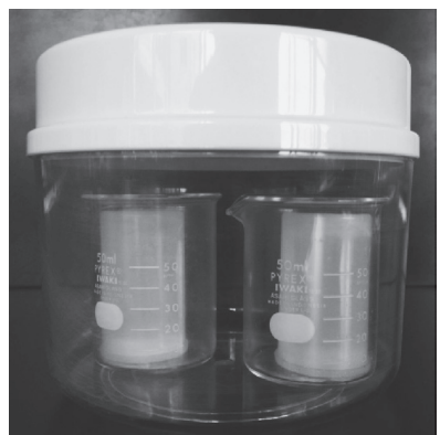
図8 簡易真空容器の蓋の上のボタンを押して空気を入れた後のようす（ビーカーに出ていた水が右のフィルムケースの中にもどる）
