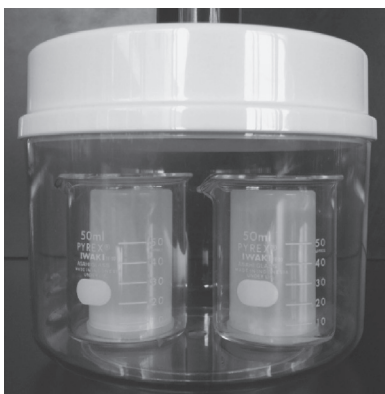
図6 簡易減圧器を使って簡易真空容器内の空気をぬく前のようす（左のフィルムケース：水のみを入れたもの、右のフィルムケース：水と空気を体積比で9：1入れたもの）
