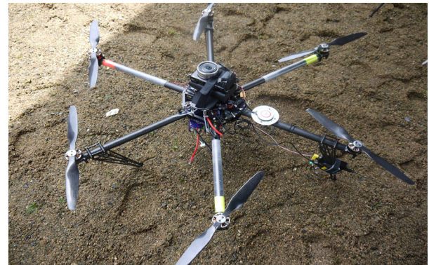
図-5 橋梁撮影用のラジコンヘリ
