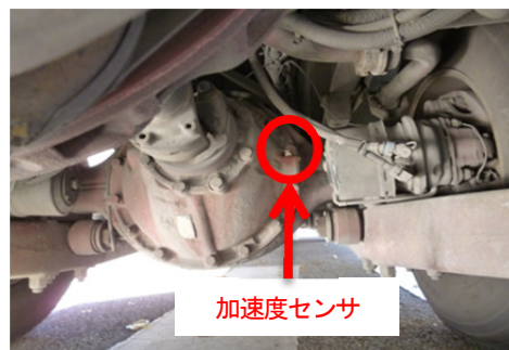
図-30 加速度センサの設置状況
