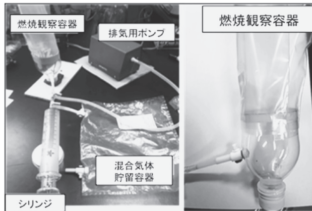
図1 燃焼観察実験装置*の概要
