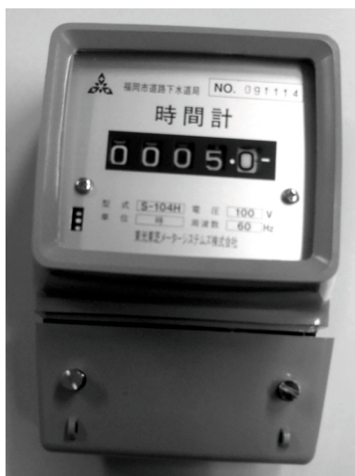
図 6-3：福岡市で使用されている地下水の揚水量の計量器の例（時間計）
