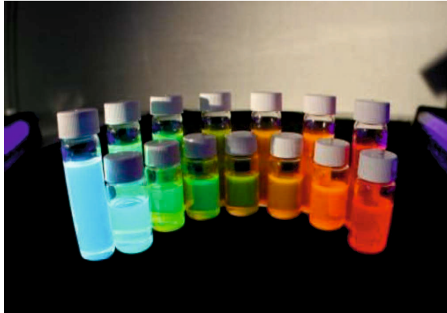
図 1. 1. Evident Technology 社 CdSe/ZnS コアシェルエヴィドット 19)
