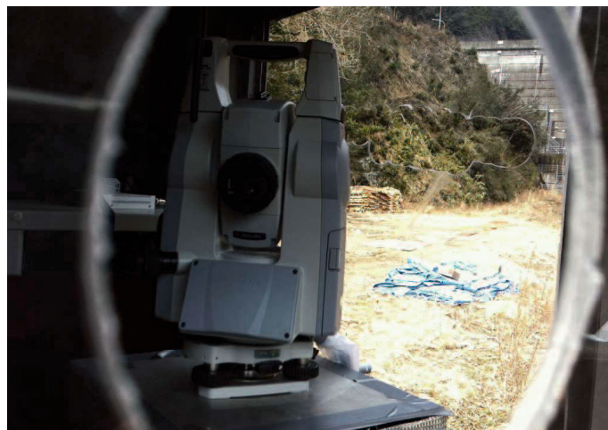
写真-1.1 観測小屋内に設置した自動追尾トータルステーション
