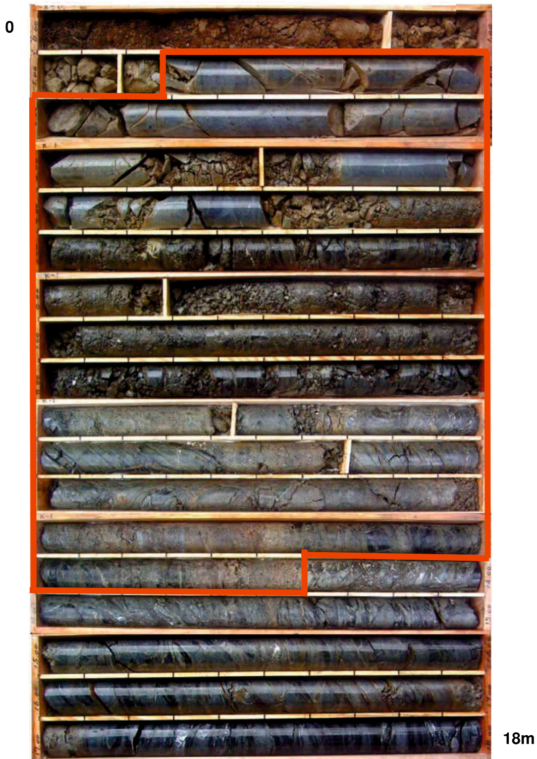
図-4.7 角礫岩のコア写真 K-1 孔 (0~18m 区間) 1.3~13.6m は角礫岩
