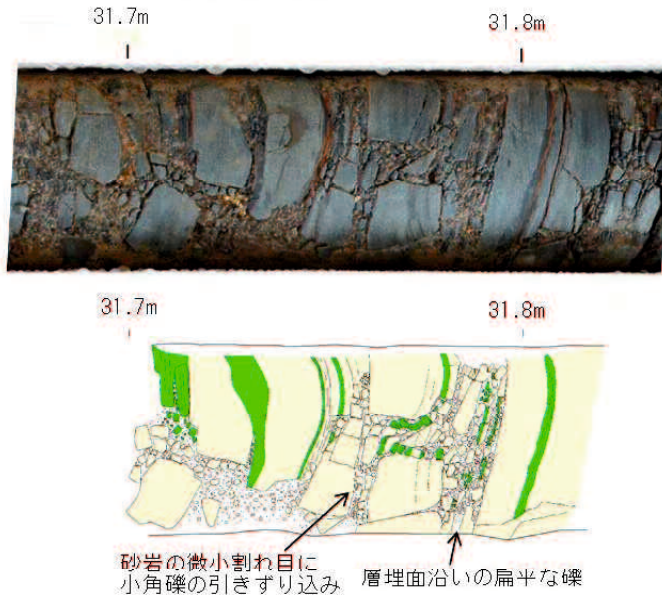
図-4.9 角礫岩のコア写真 (T14-18 孔 ; 深度 31.7~31.8m)
