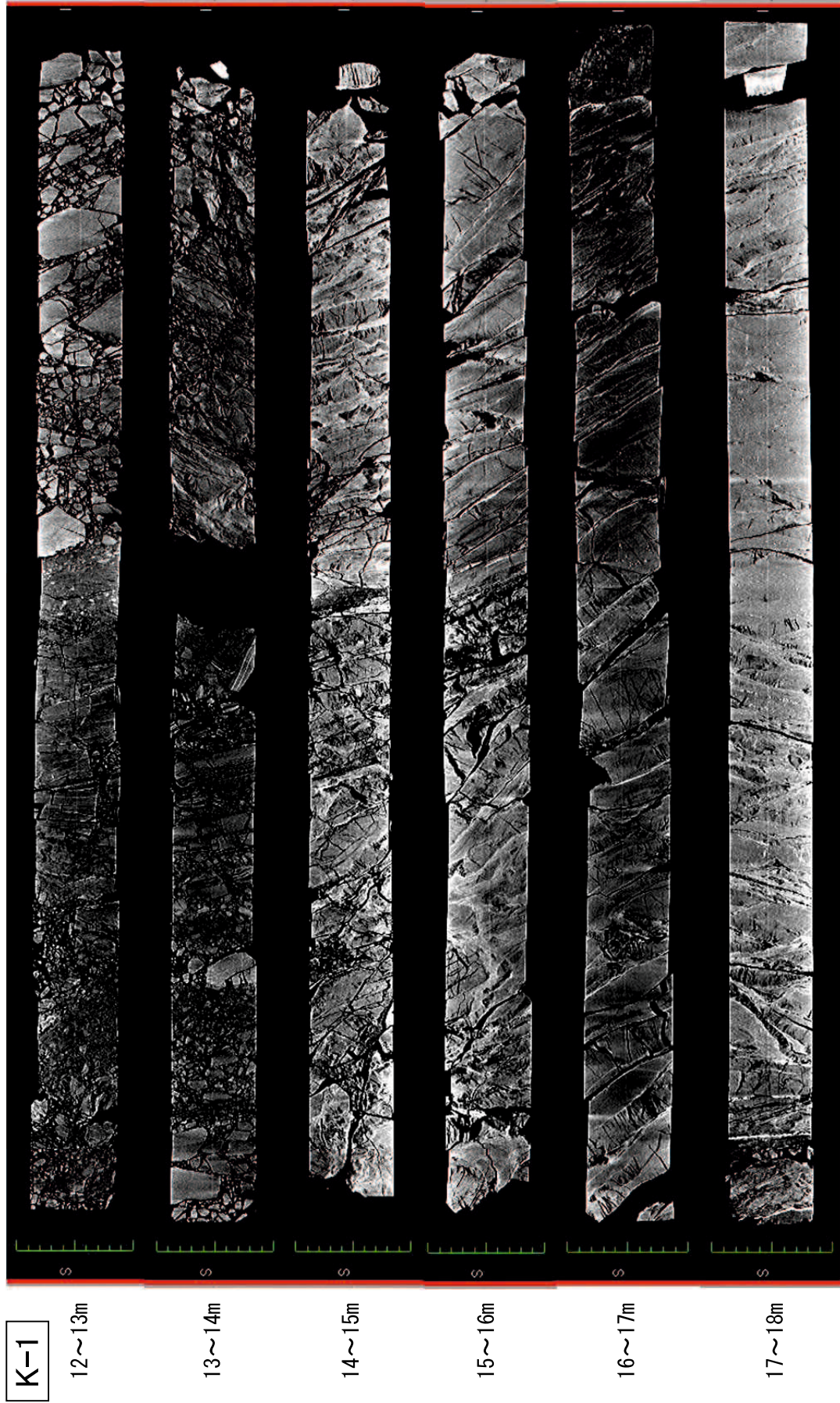
図-4.37 角礫岩コアの X 線 CT 写真 (K-1 孔 ; 深度 12~18m)
