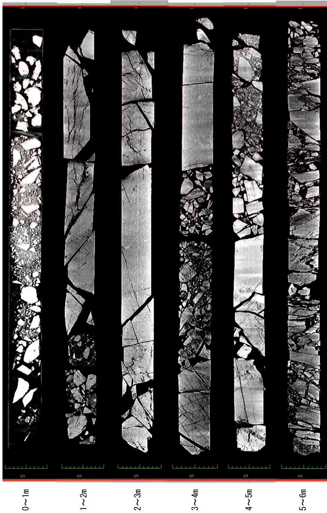
図-4.35 角礫岩コアのX線CT写真 (K-1孔 ; 深度0~6m)
