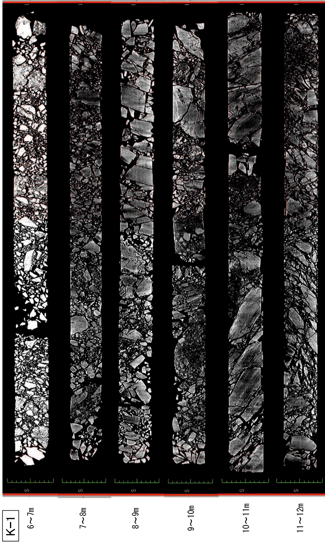
図-4.36 角礫岩コアのX線CT写真 (K-1 孔 ; 深度 6~12m)
