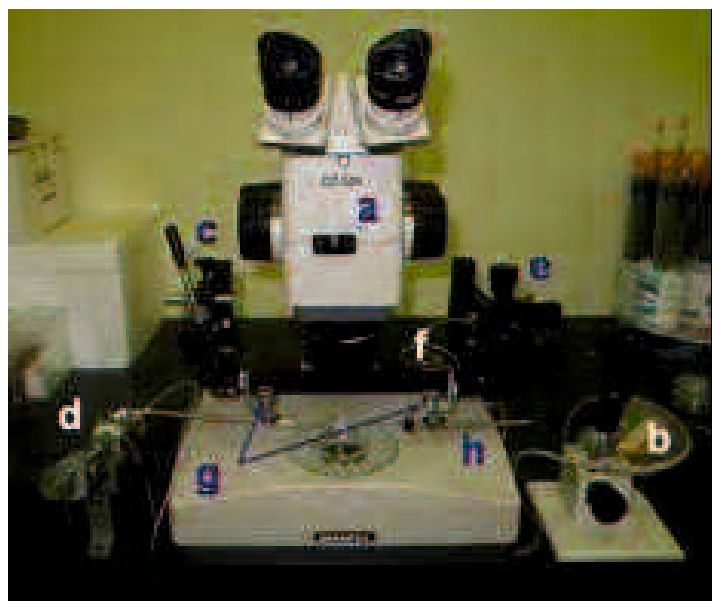
a: 実体顕微鏡, b: 三次元ジョイスティック油圧マイクロマニピュレーター, c: ジョイスティックマイクロマニピュレーター, d: マイクロインジェクター, e: マニピュレーター(粗動用), f: マニピュレーター取付アダプター, g: ボールジョイント, h: ピペットホルダー
