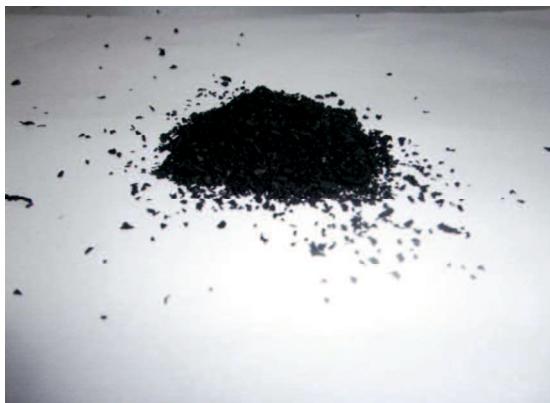
写真 3.5.2 実験に用いたタイヤチップ 写真 3.5.3 タイヤチップを詰めた穴あきビニール
