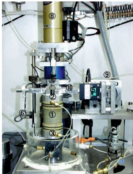
写真 3.3.1 簡易直接せん断試験装置
