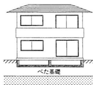
図 1.3.6 被害抑制対策：べた基礎 22)
