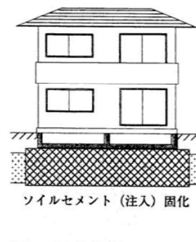
図 1.3.4 発生抑制対策：固化工法 22)
