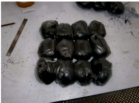
写真 3.5.2 実験に用いたタイヤチップ 写真 3.5.3 タイヤチップを詰めた穴あきビニール
