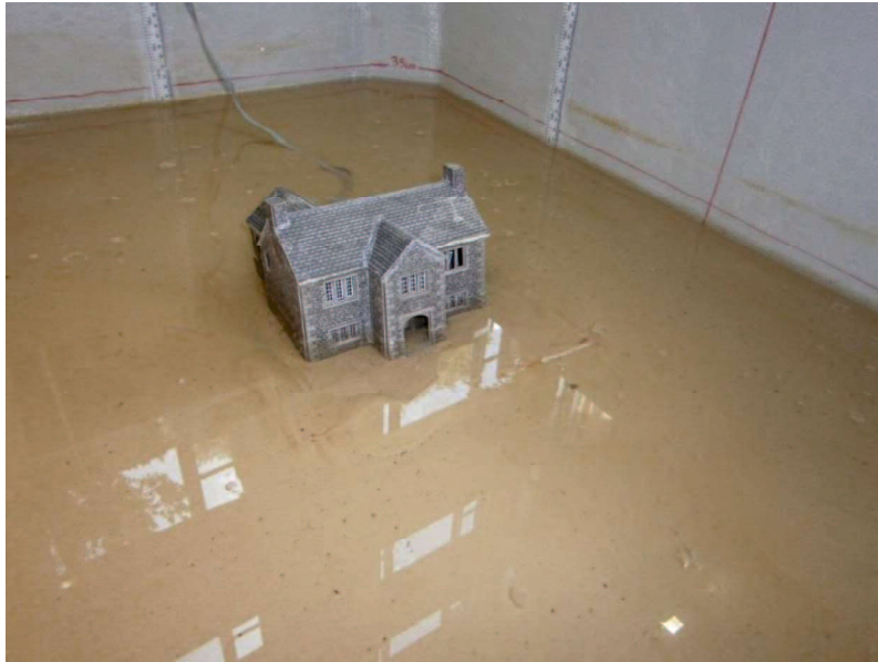
写真 3.5.8 未改良地盤モデル（基礎下地盤下にタイヤチップ層なし）
