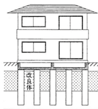
図 1.3.8 被害抑制対策： 柱状地盤改良 22)
