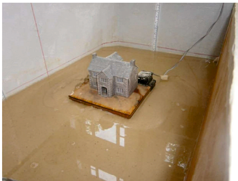
写真 3.5.7 改良地盤モデル（基礎下地盤下にタイヤチップ層あり）
