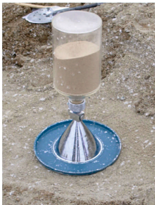
写真 3.10 現場密度試験状況
