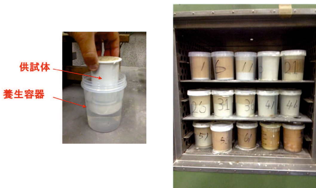
写真 4.2 養生方法および養生状況外観写真
