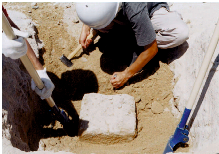
写真 3.11 ブロックサンプリング状況
