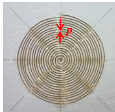
図 4. スパイラル共振器 (線間ピッチ p=5\text{mm} )
