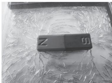
図13 フェライト磁石の磁力線
