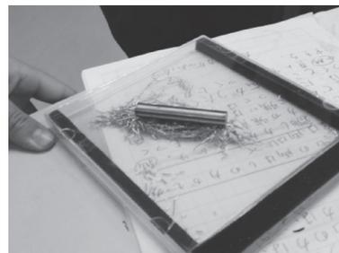
図14 アルニコ磁石の磁力線
