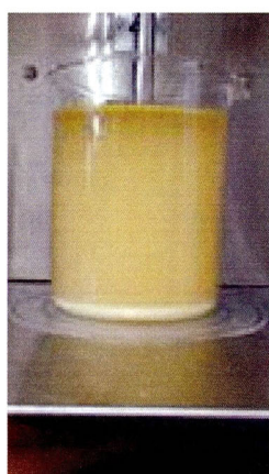
4wt%の塩化第二鉄 溶液を1%カオリン 懸濁液に10mL添加
