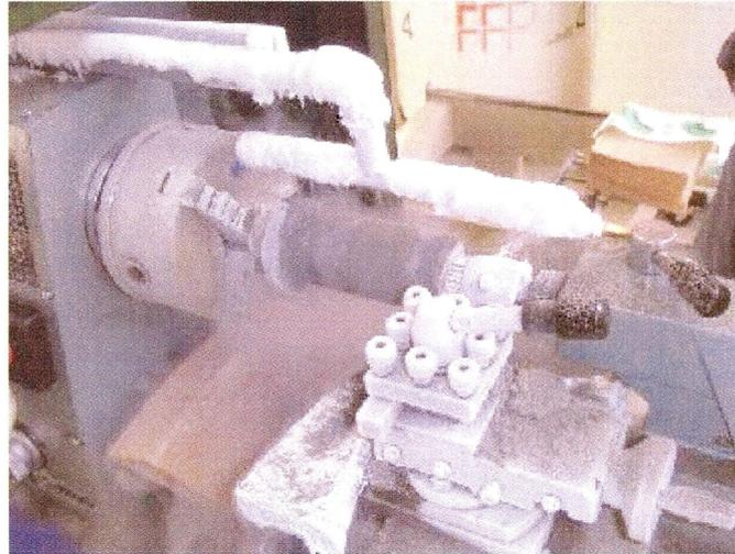
写真 2-4 MH 天然不攪乱試料整形時の様子
