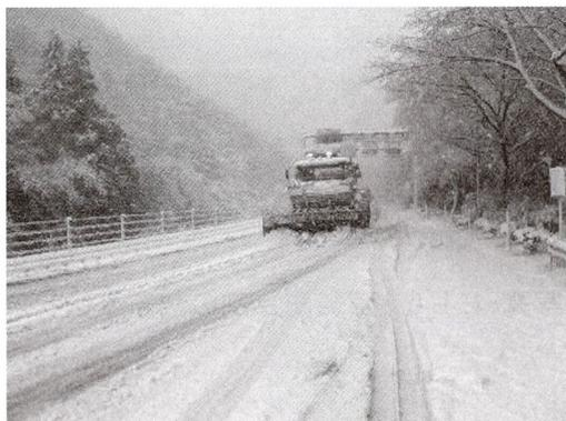
写真-1.1.1 除雪車による除雪状況
