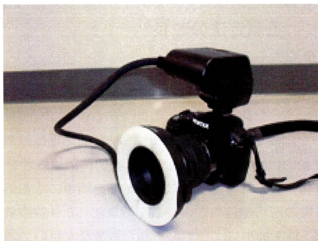
写真 4-3 リングフラッシュを取り付けた一眼レフデジタルカメラ
