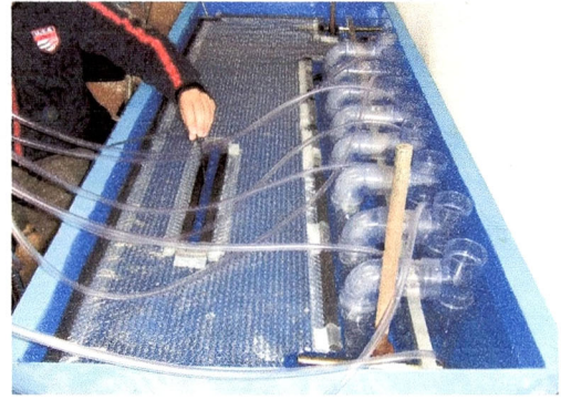
写真-Ⅱ.4 水表面シートの設置状態
