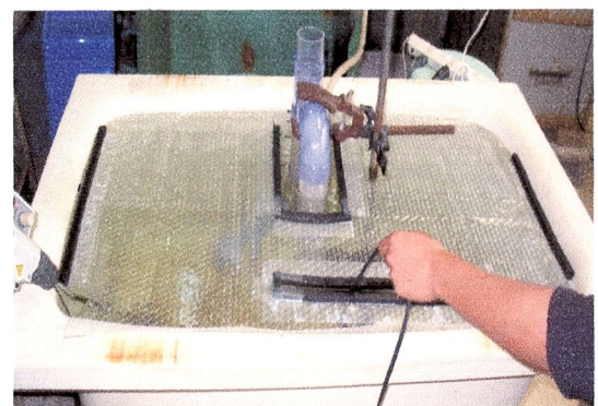
写真-3.1 水表面シートを設置した状態
