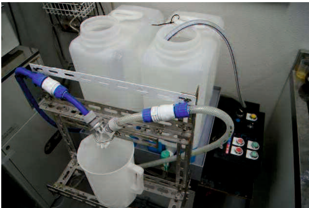
図 3-9 シリカゾル製造装置
