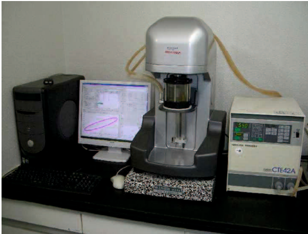
図 2-5 共軸二重円筒型レオメータとフィクスチャー
