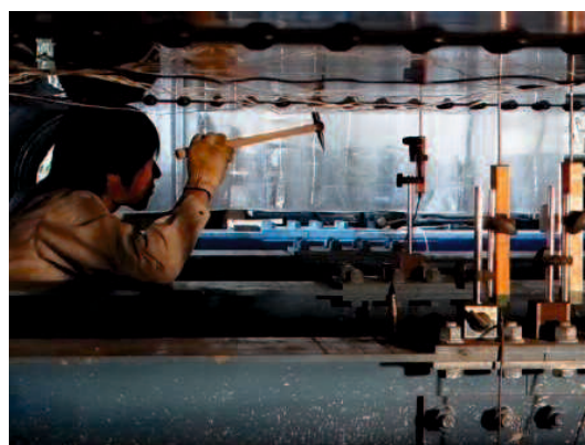
(b) 打音検査 (剥離なし)
