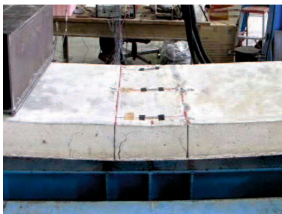
写真-6.6 静的載荷試験の破壊状況
