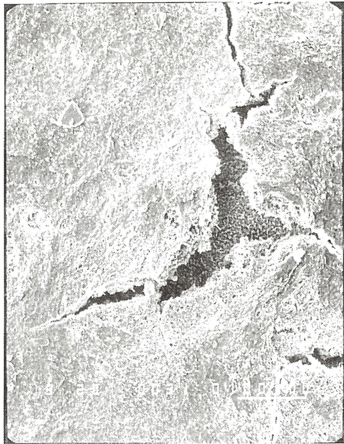
写真9-1 1年間通水後の生物皮膜の表面
