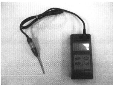
図5. 磁束密度測定に用いたテスラメーター
