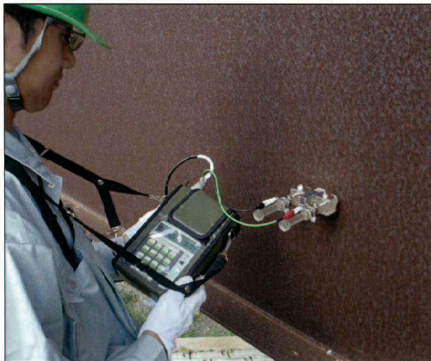
写真-2.1 改良したイオン透過抵抗測定装置による測定状況外観
