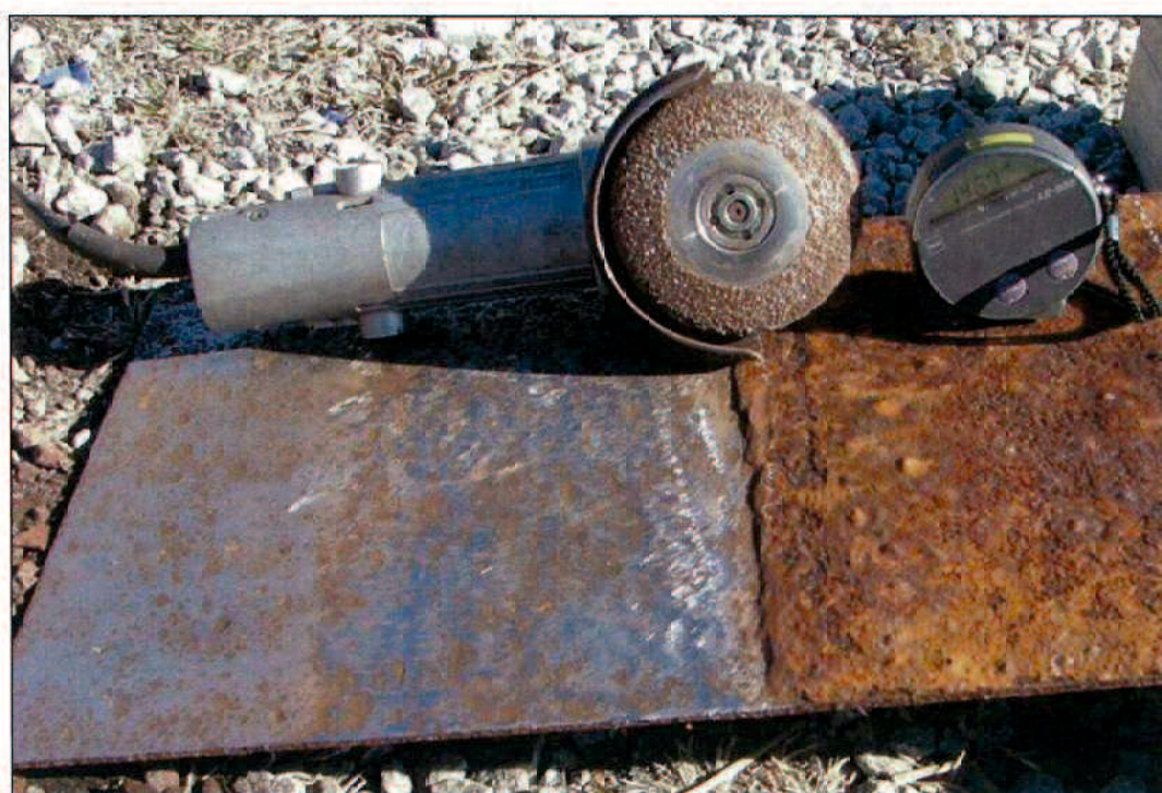
写真-6.2 異常さびが生成した耐候性鋼材における開発ダイヤモンド工具の研削状況
