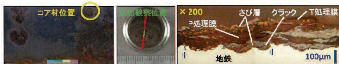
(d) 外観評点4-x, 被膜部分的に残存, 地鉄界面に消光層あり, 横クラックあり
