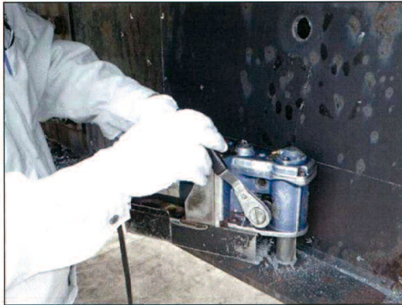
写真-3.2 コア材採取状況
