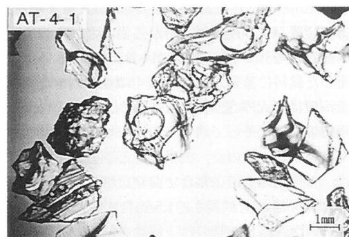
Aso-4-3 (2) では、イルメナイトが多く存在した。AT-4-1透明なバブルウォールガラスで、中央には泡が抜けた穴が楕円形に存在する。穴の直径は約1.0mmである。
