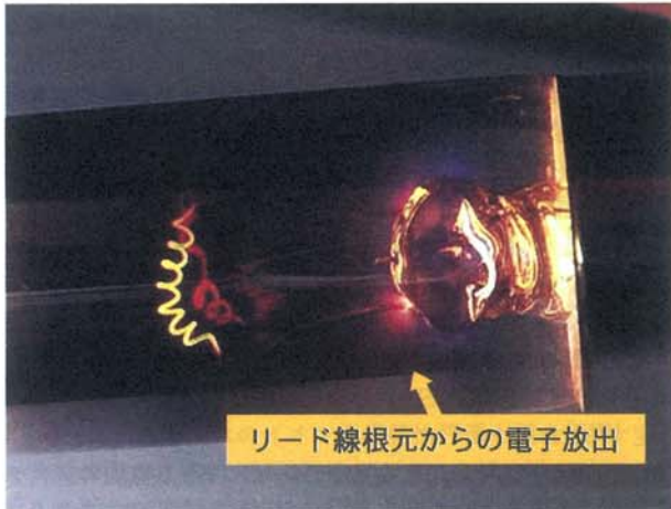
図11 間欠的スポット放電をもたらすリード線根元からの電子放出現象 (FL20SS/18)
