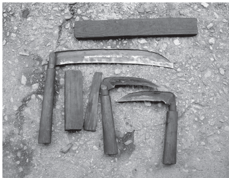
写真3 麦藁葺きの仕上げ用道具 (ヌッキーと左右のホメガマ・福岡博国氏所有)
