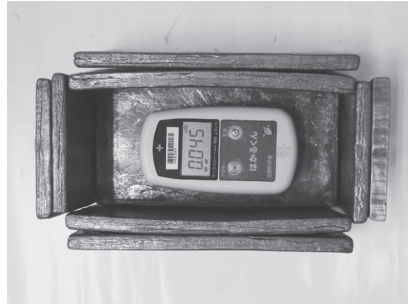
図7 遮蔽の様子。実測の時には「はかるくん」の上面にも鉛板を重ねた。
