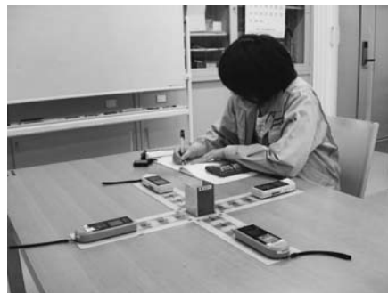
図7 はかるくん特性実験セットの遮蔽実験結果(左)と実験の様子(右)
