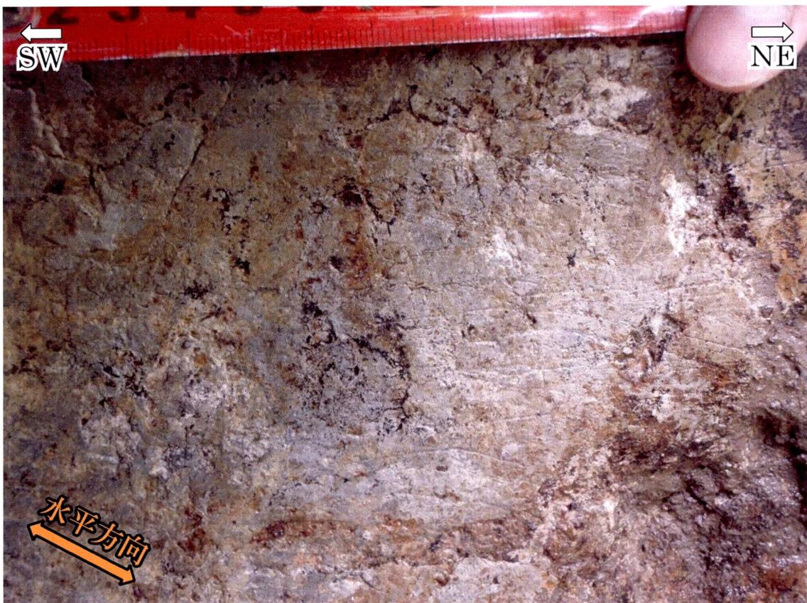
図 5.8 断層露頭 Y6 の主断層面上の条線 写真の位置を図 5.7b に示す。
