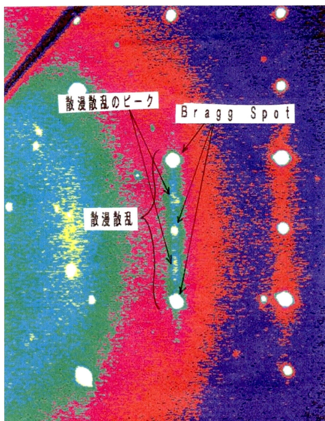
Fig.3.1.4 TMATC-Mn I相で c 軸を立てた状態でのイメージングプレート像 (振動写真) 下図は上図丸近傍の部分拡大したもの (ただし上下逆の像) 1)
