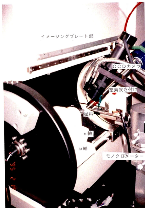
Fig.3.1.2 イメージングプレート (IP) を備えた迅速型 X 線回折装置 DIP-3000
