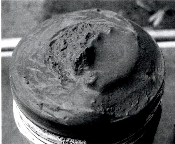
写真 3.4 加圧後のグラウト脱水（砂礫地盤）
