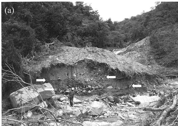
写真-3 移動域にみられる旧土石流の堆積断面 (a)剣川, (b)石原 矢印は土石流イベントを示す。
