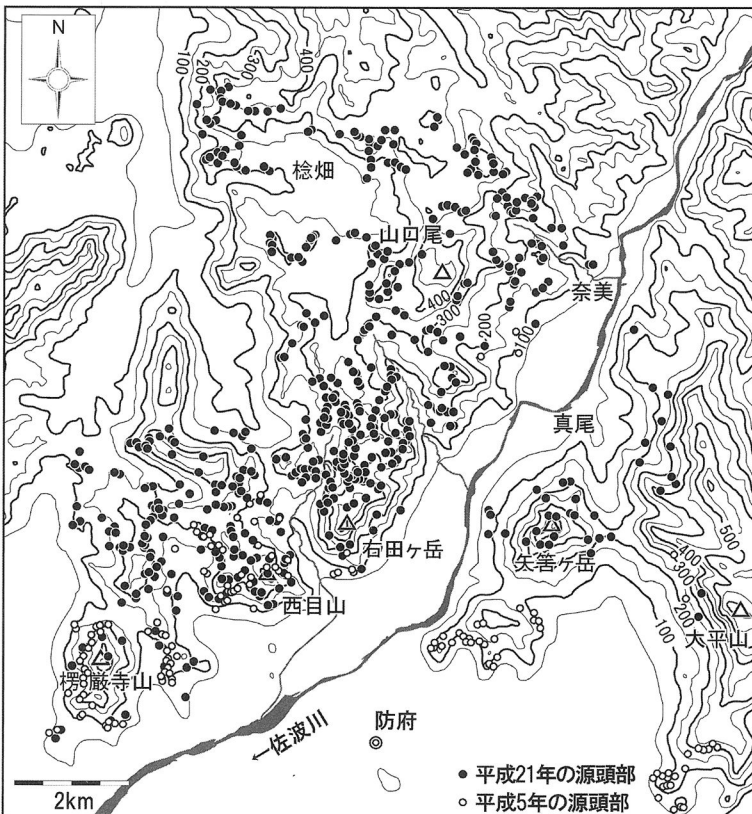
図-6 500m×500mメッシュ接峰面図と源頭部の位置
