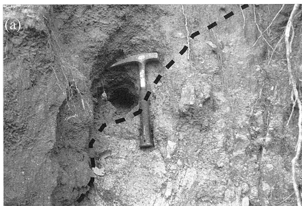
写真-2 (a)粗粒花崗岩で発生した土石流の源頭部 崩壊後の斜面には風化花崗岩Bの露出が認められ、その上位にはパイピングホールが発達する。破線は風化花崗岩Bとマサ状風化花崗岩との境界を示す。
