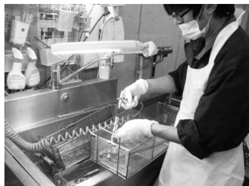
手洗い洗浄 エアーガンによる汚れ除去
