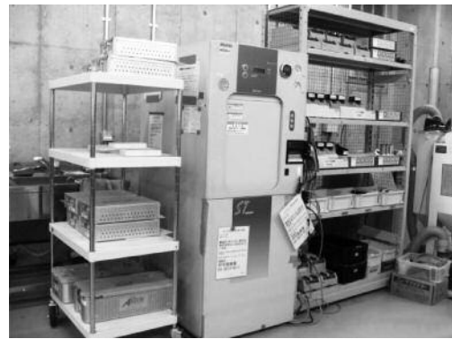
オートクレーブ（高圧蒸気滅菌処理） 温度121℃，圧力118KPa，時間20分 写真中央がオートクレーブ
