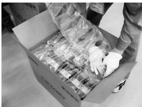
出荷梱包 エアークッション（生分解性ポリエチレン）による保護
