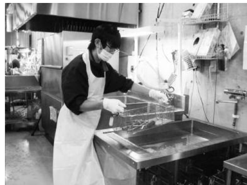
超音波洗浄器 タンパク質分解水溶液（温度40℃±5℃）に浸漬 超音波洗浄器（手前），濯ぎ用ジェット洗浄器（奥）
