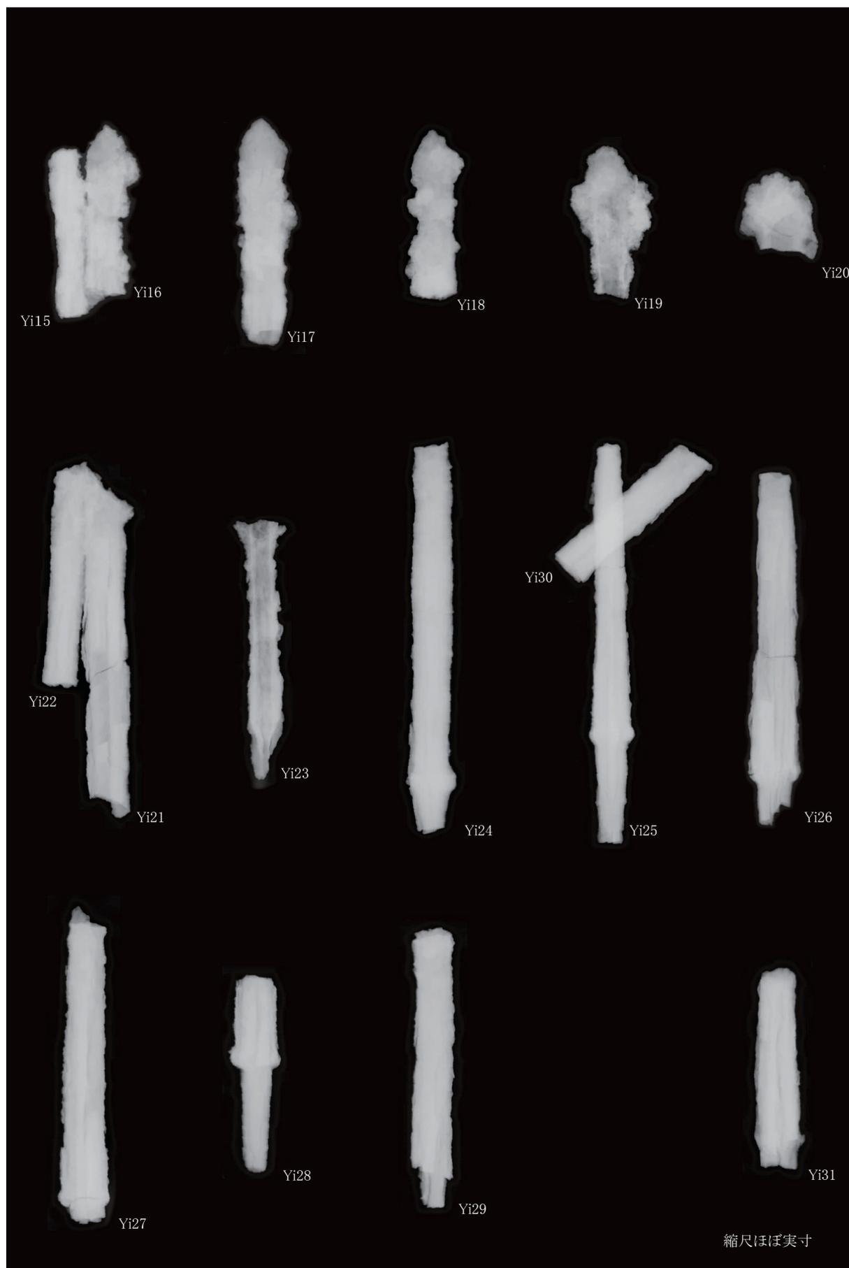
写真 18 山口大学埋蔵文化財資料館所蔵鉄器X線写真②
