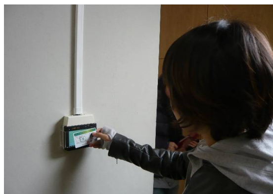
図8 IC学生証をカードリーダーにかざしている様子（出席確認システム）
